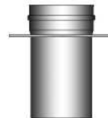
Einbau Dehnelement unterhalb des 2. T- Stücks
